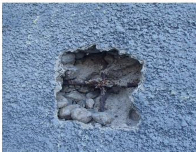
Figur 24: Opphugging i prøvefelt med typisk mye stein i betongen.
