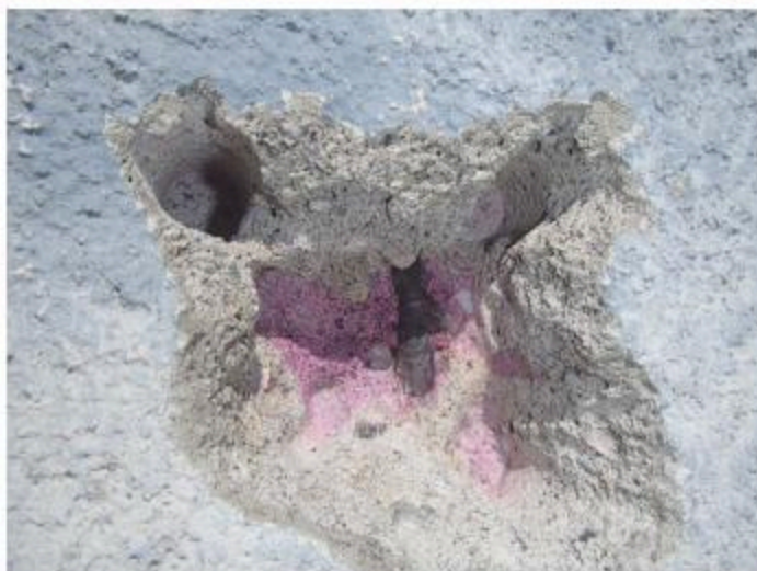
Figur 20: Typisk prøvefelt påsprøytet fenolftalinløsning.
